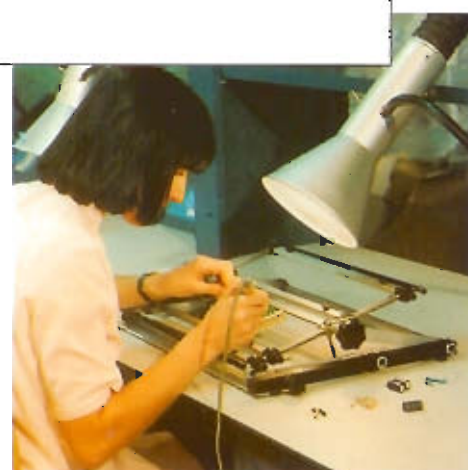
Tipica applicazione di aspirazione e filtraggio fumi da posti di lavoro. Fume extraction and filtering system from working areas.
