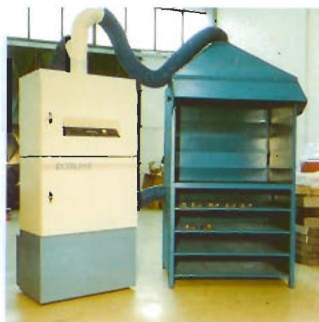
Cappa per spruzzatura schede o pozzetto di saldatura. Spraying booth for PC boards or soldering pot.
